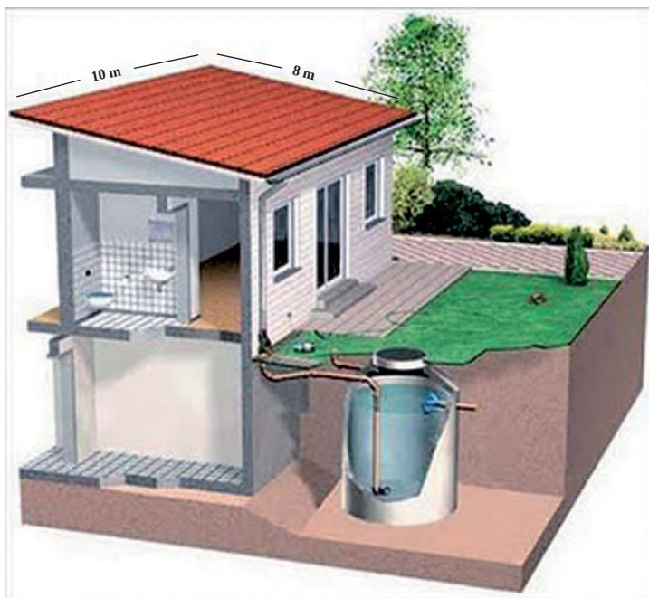
FIGURA 8 - DEMONSTRAÇÃO DE CÁLCULO DA ÁREA DO TELHADO - extraído de http://www.dicico.com.br/blog/?p=884
